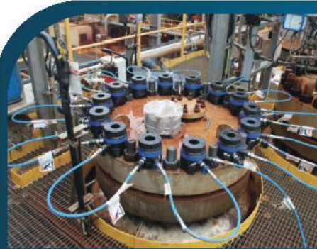
Tendeurs de M20 à M42/ 1500 BARS
